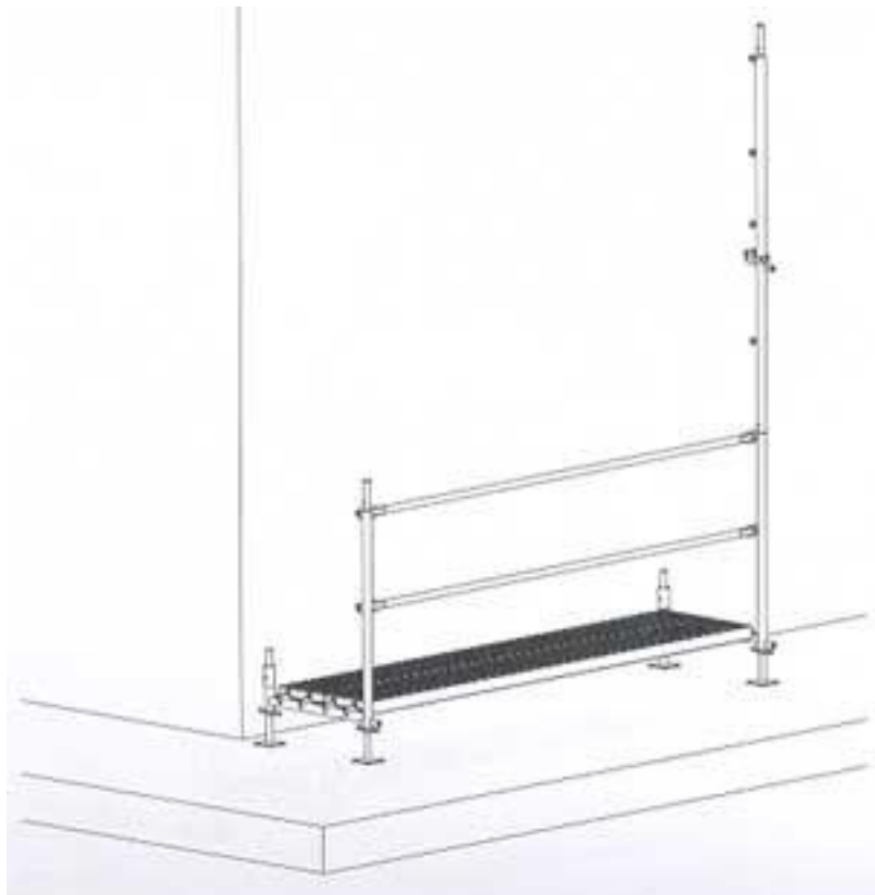
Figura 5 Inserción del marco parcial en I en el elemento de arranque
