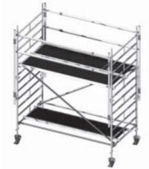
Figura 9 Finalización del piso de trabajo con barandillas y rodapiés perimetrales
