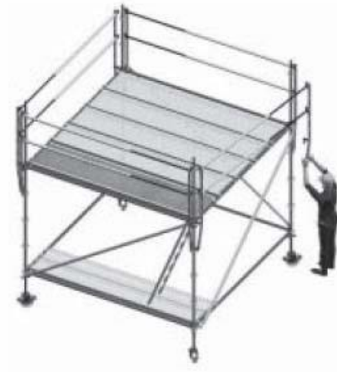
Figura 4 Montaje de la protección superior (pies y largueros de seguridad)
