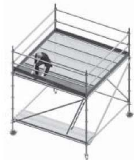
Figura 5 Montaje de barandillas y rodapiés desde el nivel superior
